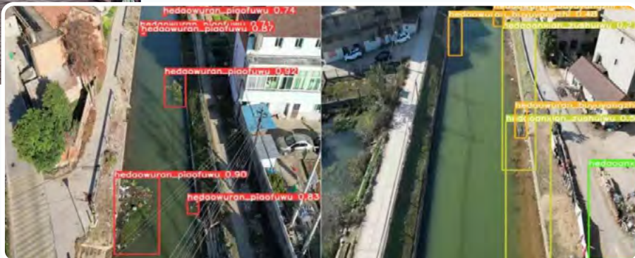
图 97：无人机开展河道 AI 自动巡检画面 供图：南昌青赣
